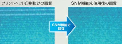
印刷抜け発生時のダウンタイムを削減するノズル代替機能が「SNM3」に進化しました。従来、手動だったノズル番号設定が自動でもできるようになりました。
