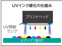
2個千鳥配列にしたプリントヘッドが1440dpiの高精細印刷を実現。デュアルUV LEDランプが22.7㎡/hの生産性を可能に。また、繊細なイメージを表現させるUVコントロール機能を搭載し、高度なニーズに対応します。
