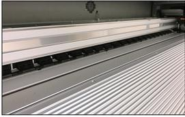
高精度アルミレール構造
